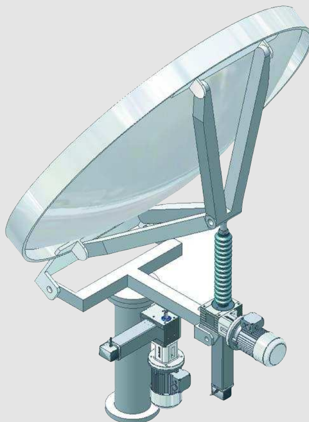
Antena paraboliczna D = 3,3 m, obydwie osie (Azimuth + Elevation) po 50 kN, przestawienie 0,02 - 0,05 mm; urządzenia te są instalowane na wolnej przestrzeni na brzegu morza.
